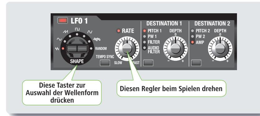
Drücken Sie den **[DESTINATION1]**-Taster und wählen Sie das Ziel für die Bearbeitung mit dem LFO. Probieren Sie den Vibrato-Effekt.
