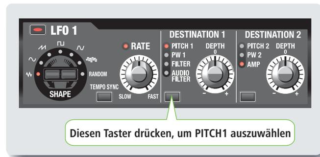
Drücken Sie den **[DESTINATION]**-Taster und wählen Sie AMP für Tremolo oder FILTER für Grownl-Effekte.
